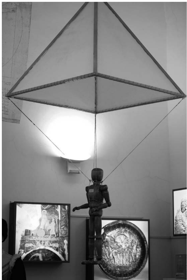
Paracadute a forma di piramide a base quadrata realizzato con una struttura in tela grossa
