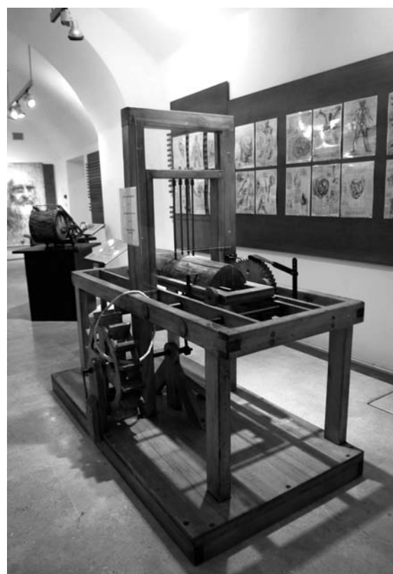
La sega idraulica che utilizza energia idrica a propulsione: consente all'uomo di tagliare il legno senza rischi
