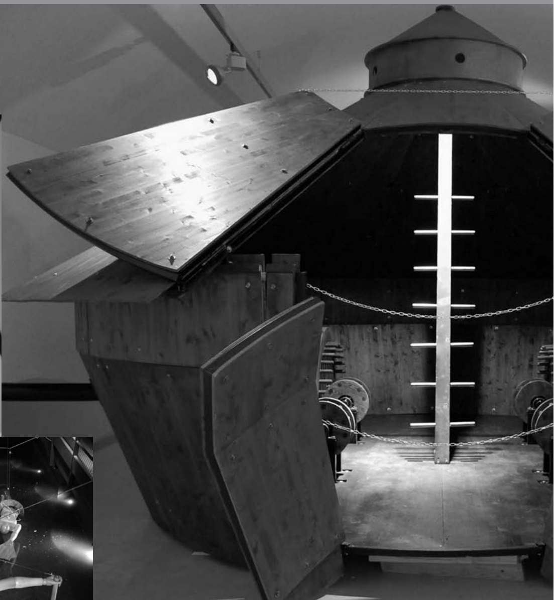
Carro armato a forma di testuggine disegnato da Leonardo nel 1485. Rinforzato con piastre metalliche è dotato di una torretta per l'avvistamento
