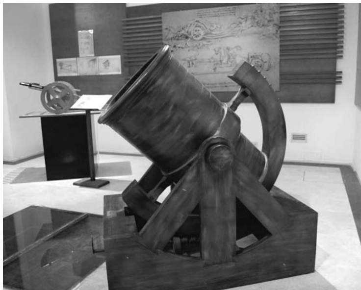
Una bombardiera costituita da una grande bocca da fuoco montata su un robusto supporto
